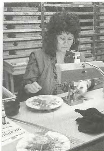
レストランではありません リードをリードプレートに 取り付けている工員 皿に入っているのはリード
